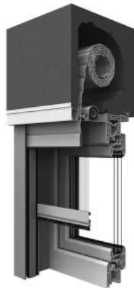
THERMplus Aufsatzelement TOP FOAM für Rollläden mit Revision von außen max. Breite: 3700 mm max. Höhe: 4000 mm max. Fläche: 8 m 2
