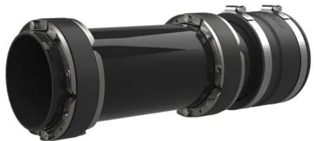
Anschlusset für Kabeleinführungssystem mit Kernbohrung/Futterrohr zum nachträglichen Einbau, Abdichtung erfolgt über Ringraumdichtungen.
