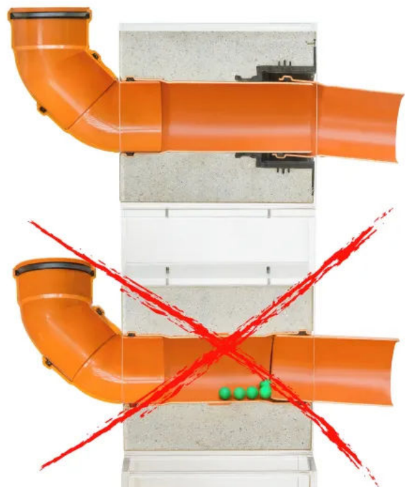
Die durchflussoptimierte Wanddurchführung UDME beugt Ablagerungen und Rückstau im Abwassersystem vor.
