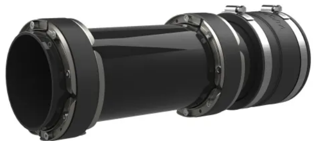
Anschlusssatz für Kabeleinführungssystem mit Kernbohrung/Futterrohr zum nachträglichen Einbau, Abdichtung erfolgt über Ringraumdichtungen.
