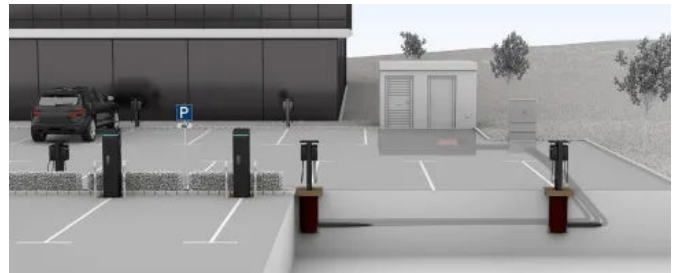
Universelle Fundamentlösung zur Installation von Ladesäulen und Ladestelen ULF
