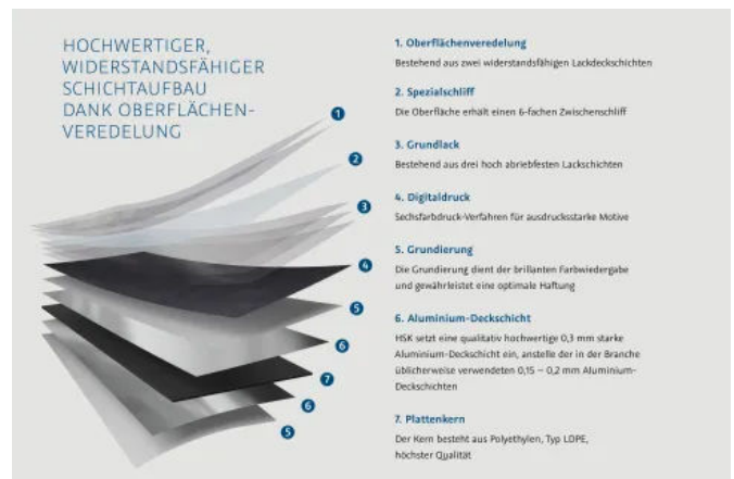
Hochwertiger, widerstandsfähiger Schichtaufbau dank Oberflächenveredelung
