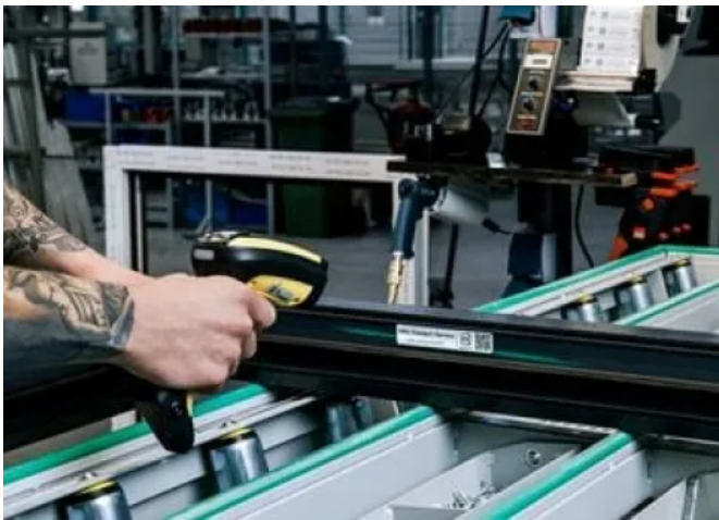
Jedes Bauteil wird mit einem Tag mit RFID-/QR-Code und einmaliger Window.ID Nummer versehen.
