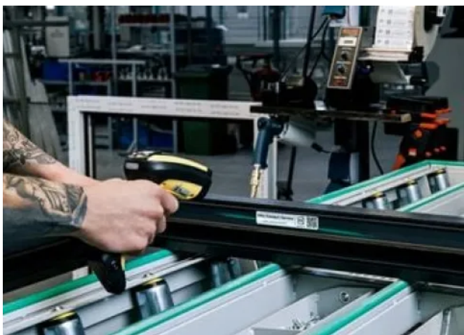
Jedes Bauteil wird mit einem Tag mit RFID-/QR-Code und einmaliger Window.ID Nummer versehen.
