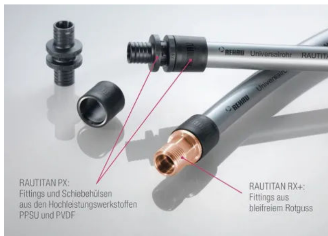
RAUTITAN: Verbindungstechnik Schiebehülse
