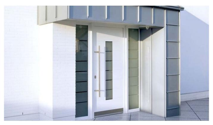
GENEO Haustürprofile aus dem innovativen Faserverbundwerkstoff RAU-FIPRO, mit einer 6-Kammer-Profilkonstruktion in 86 mm Bautiefe. Kältebrücken werden durch den Verzicht auf Stahlarmierungen vermieden. In Kombination mit Thermomodulen und einer flügelüberdeckenden Haustürfüllung erreicht die Variante GENEO PHZ für Passivhäuser einen UD-Wert von bis zu 0,54 W/(m2K).
