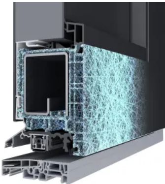
RAU-FIPRO X, Kraftzonen und verstärkte Innenstege ermöglichen eine stabile Konstruktion bei schlanken Ansichten. Flügelüberdeckende Füllungen sowie kantige Überschläge mit reduzierten Radien prägen die Aluminium-Anmutung.
