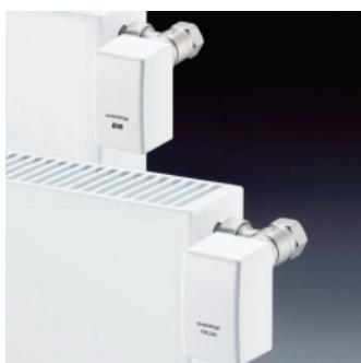
Der elektromotorische Stellantrieb EIB ist geeignet für den Direktanschluss an den europäischen Installationsbus. Der elektromotorische Stellantrieb LON® ist geeignet für den Direktanschluss an LONWORKS®-Netzwerke. Die Stellantriebe für die beiden Bussysteme verfügen zusätzlich über einen integrierten Binäreingang, an dem z. B. ein Fensterkontakt angeschlossen werden kann.
