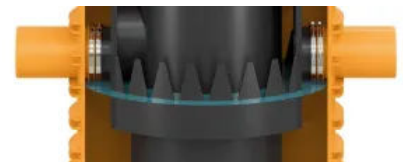
Das Zackenwehr verhindert Kurzschlussströmungen bei Starkregenereignissen.
