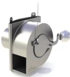
Die ACO Q-Brake Wirbeldrossel ist eine vertikale Wirbeldrossel-Abflusssteuerung, die zur Regulierung von Regenwasser entwickelt wurde, bevor es in Vorfluter oder Abwasserkanäle entleert wird. Anders als bei herkömmlichen Methoden, so zum Beispiel bei Drosselblenden oder bei dimensionierten Rohren, ist die Q-Brake Wirbeldrossel von ACO weniger blockieranfällig und ermöglicht einen höheren Abfluss auch bei geringer Aufstauhöhe.
