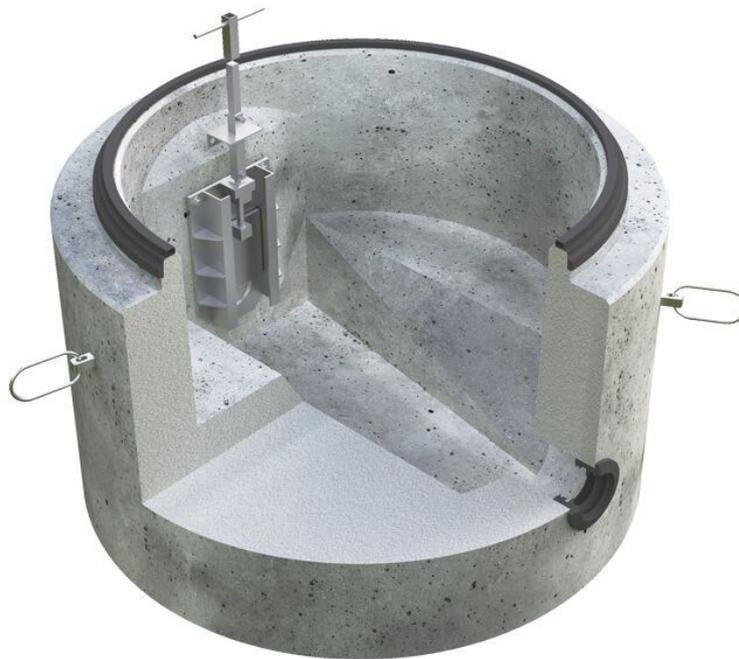
Drosselsysteme wie z. B. statische Blenden und Drosselschieber zur Drosselung des Regenwasserabflusses aus dem Regenrückhaltebecken. Die Drosselschächte werden individuell geplant.
