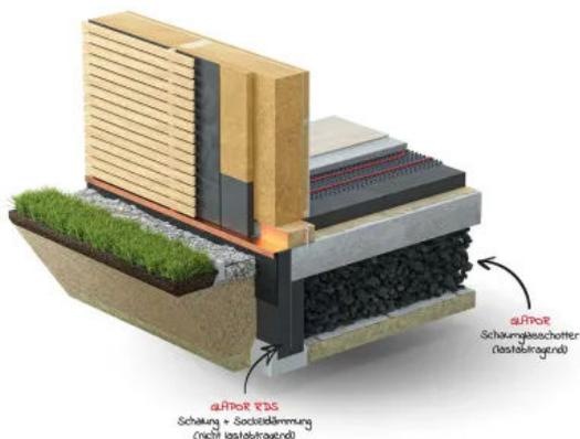
Der GLAPOR Schaumglasschotter ist hoch druckbelastbar, nagetiersicher und bietet gleichbleibende physikalische und bauphysikalische Eigenschaften über die gesamte Nutzungsdauer. Eine Aufwechtlung des Dämmstoffes ist nicht möglich. Zudem ist GLAPOR Schaumglasschotter rückbaubar und wiedereinsetzbar. Ideale Voraussetzung für moderne Urban Mining und cradle-to-cradle Betrachtungen.
