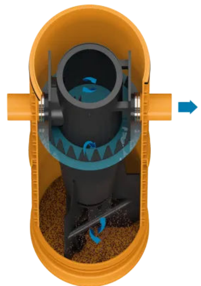
So funktioniert die Reinigung mit RAUSIKKO SediShark
