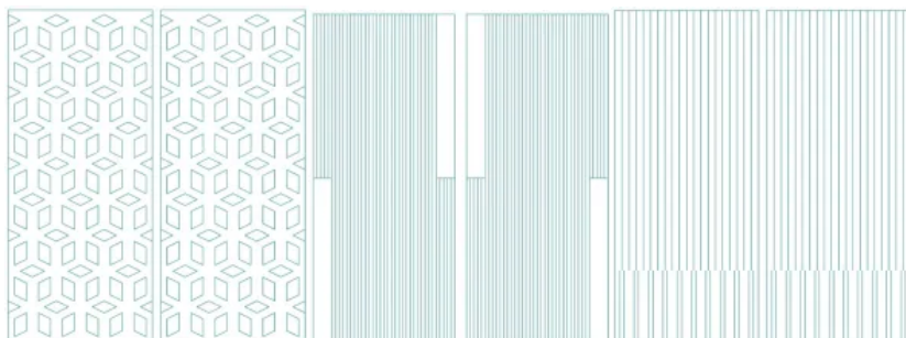
Cube: 2 gleiche Paneele mit einer Größe je Exzentric: 2 gespiegelte Paneele mit einer Größe je Panel von 1205x2780 mm
