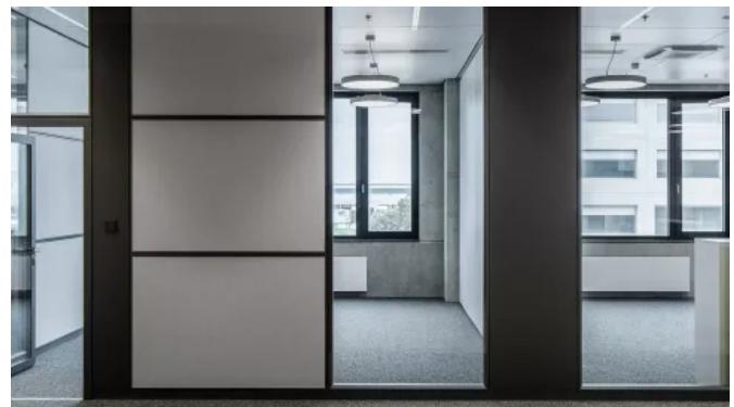
Ausführung basiert auf dem Trennwandsystem PANframe mit deckenintegrierter Lüftung und Beleuchtung
