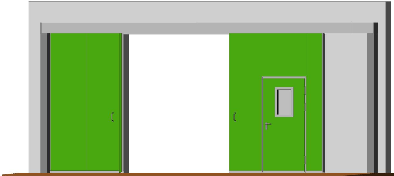
Rauchschutztüren /-tore mit Schiebeflügel in den Abmessungen (B x H in mm) von 1.000 x 1000 bis 7.000 x 4.500.
