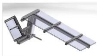
Einzelflappe im vertikalen Bereich eines Sheddaches
