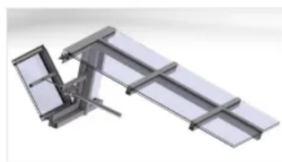
Einzelflappe im vertikalen Bereich eines Sheddaches
