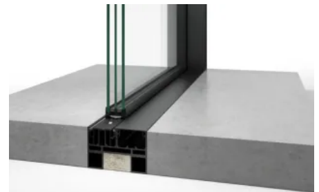
free: Trotz des geringen Platzes ist im Blendrahmen die gesamte Laufmimik untergebracht. Im Ergebnis ist eine 100% barrierefreie Schwellenausführung entstanden.
