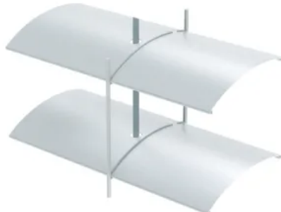
ARB 80 WS - Bis zu 72 km/h hält der windstabile Raffstore mit 80 mm C-Lamelle stand
