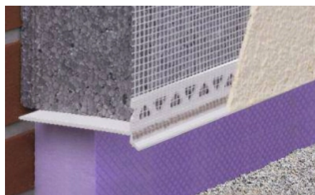
Wärmebrückenoptimierte PVC-Sockelprofile mit Glasfasergewebe für rückspringende Sockel, zum Einschieben zwischen Fassaden- und Perimeterdämmung.
