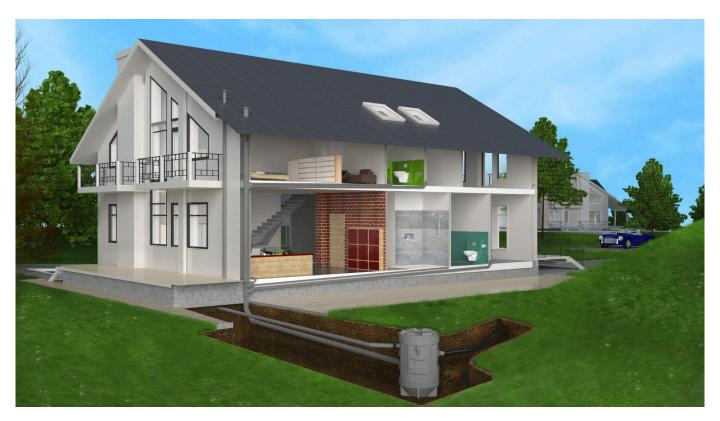
Sanifos Pumpstationen leiten Abwassermengen effizient ab und verhindern einen Rückstau in das Abwassersystem eines Gebäudes. Sie kommen überall dort zum Einsatz, wo der Betrieb einer Pumpe außerhalb des Gebäudes notwendig oder gewünscht ist – ob im privaten, gewerblichen oder öffentlichen Bereich.
