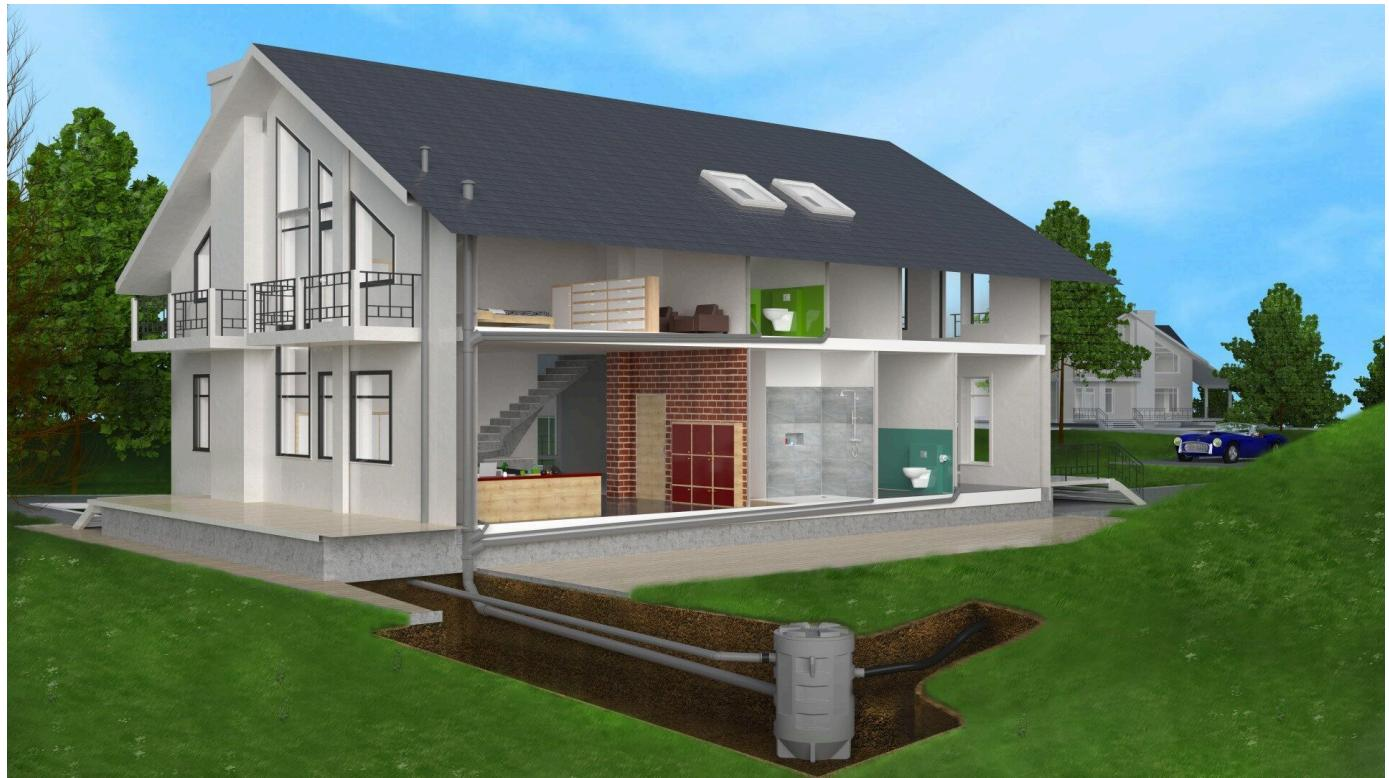
Sanifos Pumpstationen leiten Abwassermengen effizient ab und verhindern einen Rückstau in das Abwassersystem eines Gebäudes. Sie kommen überall dort zum Einsatz, wo der Betrieb einer Pumpe außerhalb des Gebäudes notwendig oder gewünscht ist – ob im privaten, gewerblichen oder öffentlichen Bereich.
