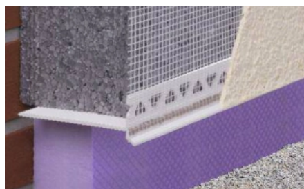
Wärmebrückenoptimierte PVC-Sockelprofile mit Glasfasergewebe für rückspringende Sockel, zum Einschleiben zwischen Fassaden- und Perimeterdämmung.
