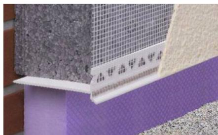
Wärmebrückenoptimierte PVC-Sockelprofile mit Glasfasergewebe für rückspringende Sockel, zum Einschleiben zwischen Fassaden- und Perimeterdämmung.
