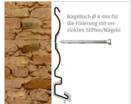
Das zentrale Nagelloch liegt plan auf dem Putzgrund auf, dadurch wird die maximale Befestigungsfläche genutzt.
