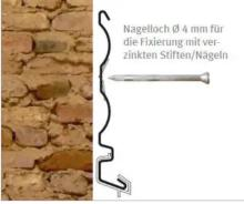
Das zentrale Nagelloch liegt plan auf dem Putzgrund auf, dadurch wird die maximale Befestigungsfläche genutzt.
