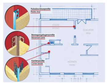
Mit speziellen Putzprofilen für Ecken, Bewegungsfugen oder Abschlüssen können alle Putzflächen fachgerecht und zeiteffizient ausgeführt werden.
