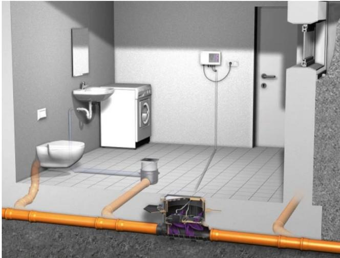
Dank Rückstauverschluss Staufix FKA kann auch unterhalb der Rückstauenebene ein WC eingebaut werden. Hier das Modell für den Einbau in die Bodenplatte.
