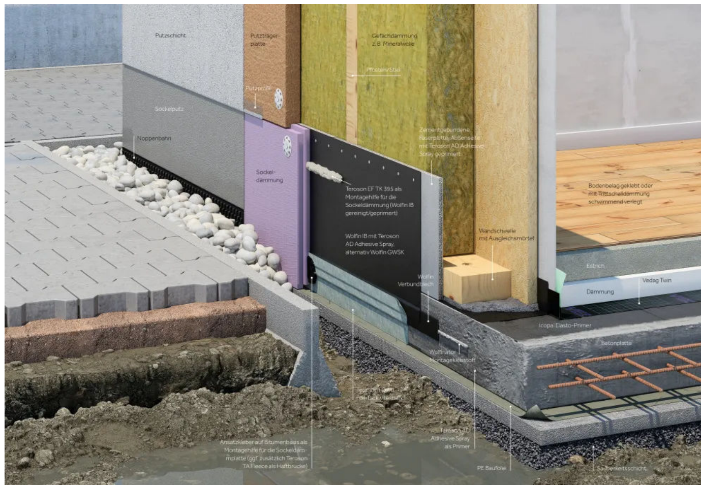
Variante 1 | Sockelabdichtung und Spritzwasserschutz im Holzbau
