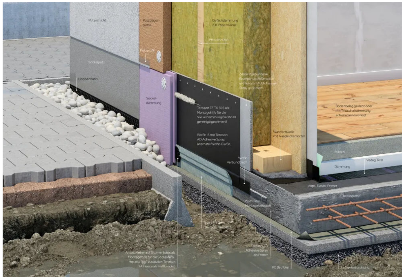
Sockelabdichtung und Spritzwasserschutz im Holzbau
