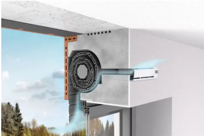
Aireco® ist von außen nahezu unsichtbar und innen durch eine Innenblende in unterschiedlichen Designs verdeckt.
