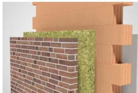
Zweischalige Ziegel-Wandsysteme haben sich bewährt für langlebige Klinkerfassaden und energieautarke Gebäudekonzepte.
