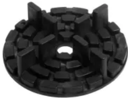
STANDARD (teilbar), Ø 120 mm, h 10 mm, hier mit Fugensteg 6x20 mm
