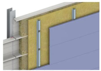
Hinterlüftete Fassade – waagerecht auf Kassetten-Innenschale mit vorgesetzter Dämmung als zugelassenes System
