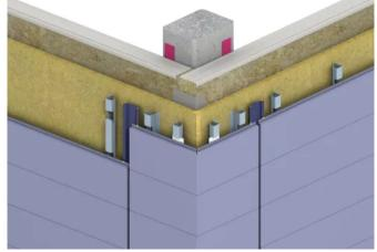
Außenecke als Eckelement – Planum waagerecht auf Kassetten- Innenschale mit vorgesetzter Dämmung
