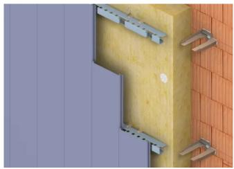
Hinterlüftete Fassade – senkrecht auf Mauerwerk mit Dämmung
