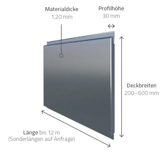
Die Planum<sup>®</sup> INOX-Fassade mit einer maximalen Deckbreite von 600 mm ist eine Kombination aus verzinktem Stahl als Trägermaterial mit einer Edelstahl Oberfläche. Zusätzlich kann eine Nano Keramikbeschichtung (Antifingerprint, Selbstreinigungseffekt) auf die durch ein PVD-Verfahren Titan gehärtete Edelstahlschicht aufgebracht werden.
