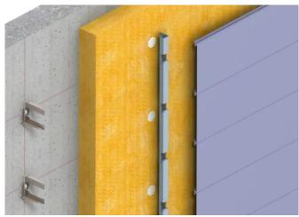
Hinterlüftete Fassade – waagerecht auf Betonwand mit Dämmung
