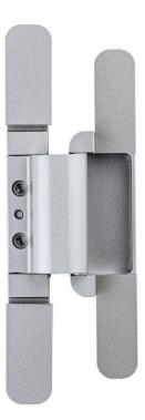
Das "PIVOTA® FX-Türbandsystem" ist die verdeckt liegende Lösung für überfälzte Türen. Es erlaubt einen Öffnungswinkel von 180° und ist dreidimensional verstellbar.
