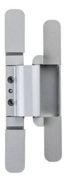
Puristische Optik beim neuen "PIVOTA® FX2 80 3-D": Magnetisch gehaltene Abdeckplatten verdecken die Schraubenbereiche bei dem verdeckt liegenden Band für gefälzte Normtüren im Innenbereich. Foto: BaSys
