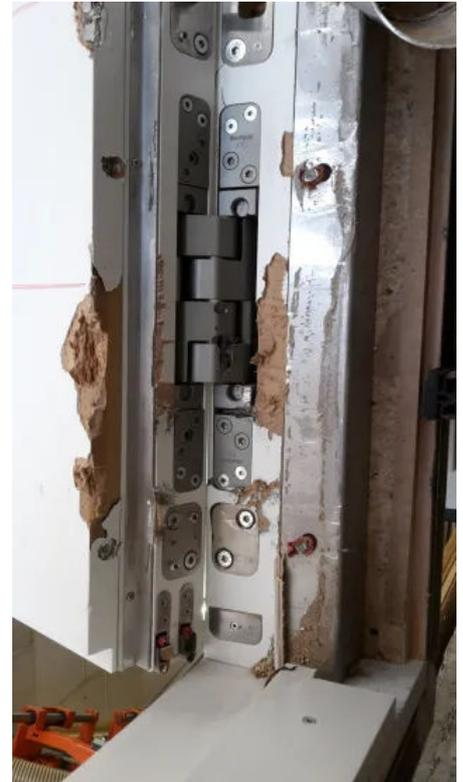
Das „PIVOTA® DXS 300 3-D“ weist eine Tragfähigkeit von 350 Kilogramm pro Paar auf und besteht ausschließlich aus Stahl. Dadurch erreicht das Band die Einbruchhemmung der Widerstandsklasse RC4. Das Bild zeigt das Band nach bestandener Einbruchprüfung. Foto: Huber Form Schreinerei GmbH, Triftern-Neukirchen
