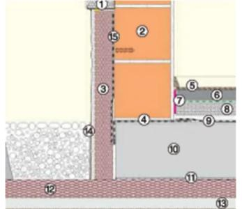
Austrotherm Sockelausführung bei Gründung mit Plattenfundament und Frostschürze
