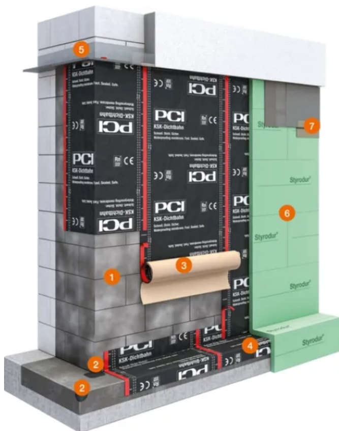
Bauwerksabdichtung KSK (kaltselfstklebende Bitumen-Dichtbahn)
