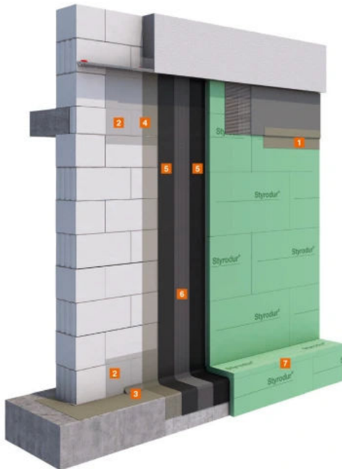
Bauwerksabdichtung PMBC (polymermodifizierte Bitumen-Dickbeschichtung)
