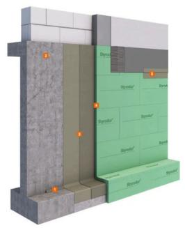
Bauwerksabdichtung flexible 2K-Reaktivabdichtung (flexible mineralische Dichtschlämme) gem. DIN 18533 Teil 3
