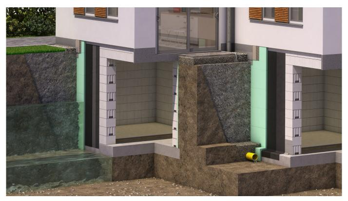
Die dreiteilige DIN 18533 gilt für die Abdichtung erdberührter Wand- und Bodenflächen, von Wandquerschnitten und Sockelbereichen von Hochbauwerken sowie von erdüberschütteten unterirdischen Bauwerken in offener Bauweise.
