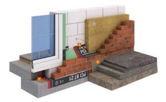
Bauwerksabdichtung KSK gem. DIN 18533 Teil 2 System PCI BT 21 zweischaliges Mauerwerk
