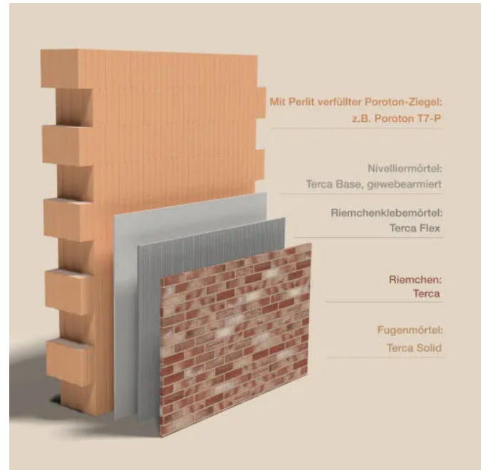
wienerberger ONE ist ein Ziegel-Wandssystem mit integrierter Dämmung und keramischer Riemchenfassade.
