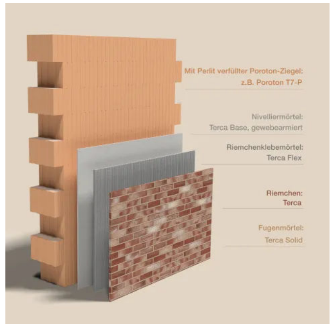
wienerberger ONE ist ein Ziegel-Wandssystem mit integrierter Dämmung und keramischer Riemchenfassade.
