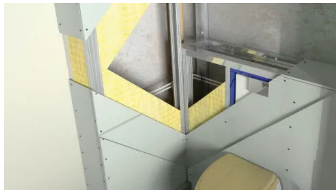
Vorwandkonstruktionen vermeiden Stemmarbeiten bei Nachinstallationen.
