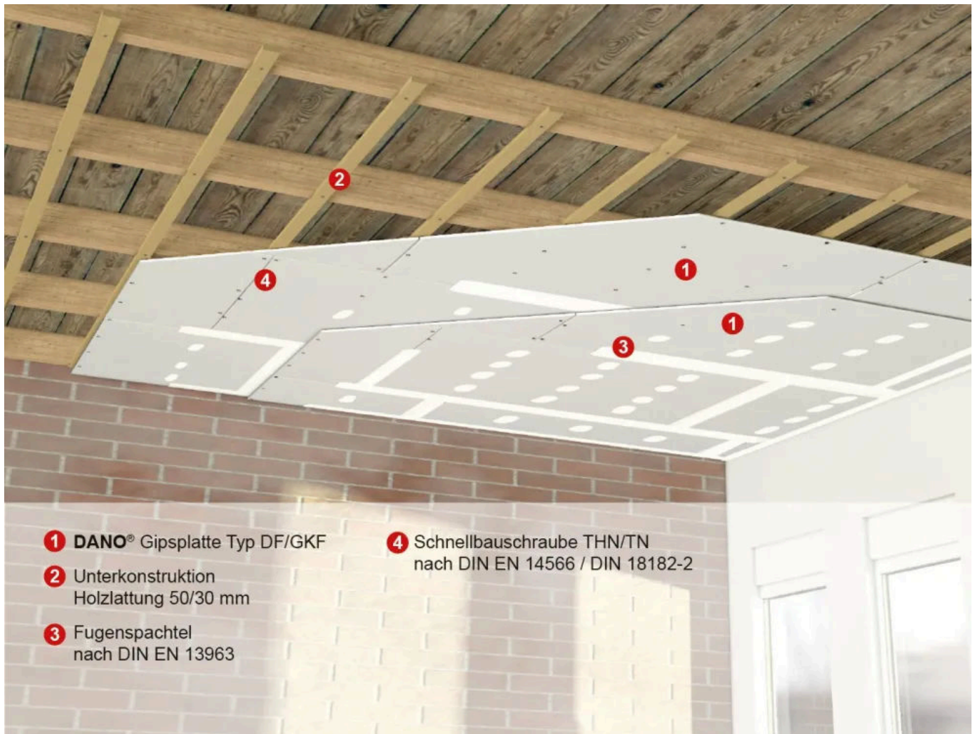
D 60-51 Unterdeckenbekleidung F60-B (15 + 18 mm Dano® Feuer DF/GKF)
