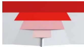
Q3: Sonderverspachtelung, Q2 breiter auspachteln für fein strukturierte Wandbekleidungen, Anstriche oder Oberputze (Größtkorn \leq 1 mm)
