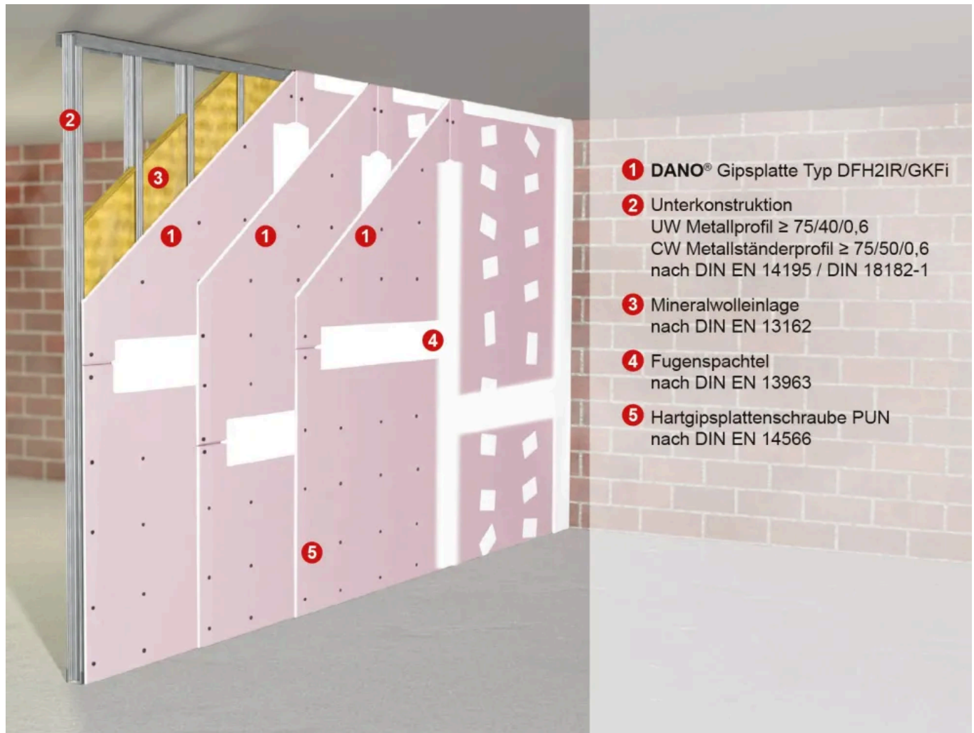
W 90-90 Einbruchhemmende Metallständerwand RC2 mit DANO® Stabil DFH2IR/GKFi
