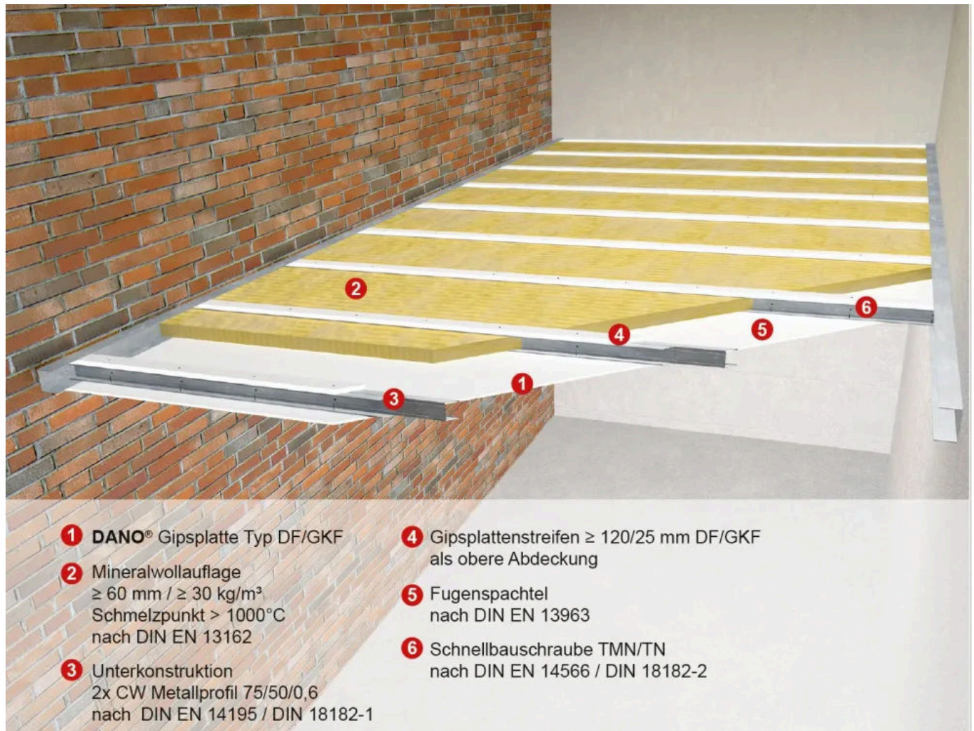
D 30-72 Unterdeckenbekleidung F30-A (1 x 18 mm DANO® Feuer DF/GKF)
