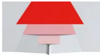
Q2: Standardverspachtelung, Q1 stufenlos angleichen für Raufasertapeten, matte/füllende Anstriche, Oberputze (Größtkorn \geq 1 mm)
