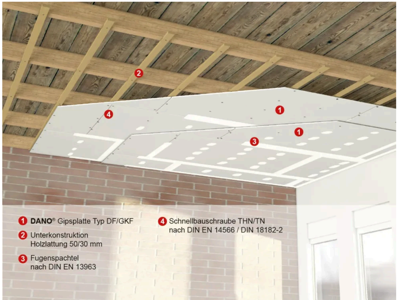
D 60-51 Unterdeckenbekleidung F60-B (15 + 18 mm Dano® Feuer DF/GKF)
