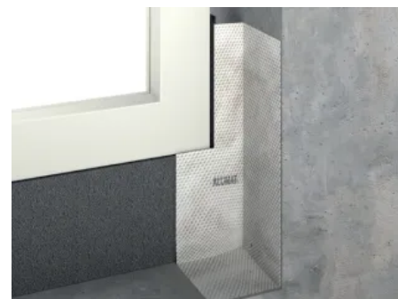
Vlies kann der Laibung angepasst werden
