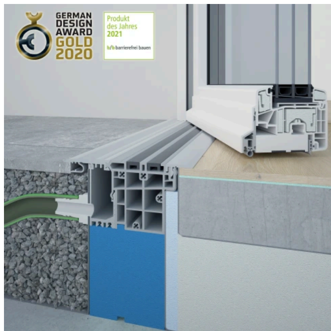
Tür offen – Magnete unten (schwellenloser Übergang)
