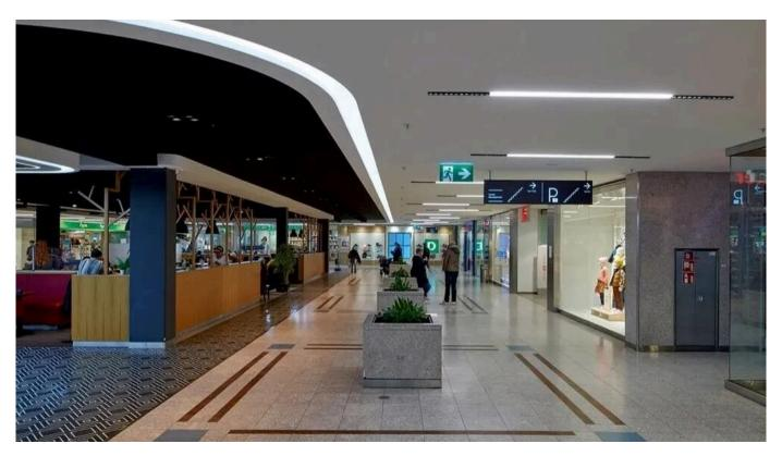
Das Trockenbau-Deckensystem NoLimit Plus vereint Beleuchtung und Lüftung in einer vorgefertigten Baugruppe, die sich nahtlos in die Decke integrieren lässt. Durch die rahmenlose, deckenbündige Montage entsteht ein planer Deckenspiegel, der technische Komponenten nahezu unsichtbar macht.
