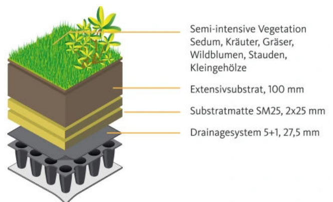
MOGAT-Gründach GS Dura Premium+ (179 kg/m²) 78 Liter Wasserspeicher/m²
