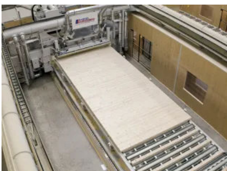
Fertigung der einzelnen Wand-, Boden- und Deckenelemente
