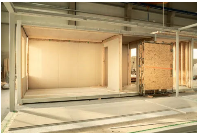
Vorfertigung der Holz-Hybrid-Module im Werk
