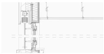
$Wandaufbau\ von\ außen\ nach\ innen:\ Fassadenbekleidung\ auf\ Unterkonstruktion,\ Hinterl\"uftung,$ vileskaschierte Mineralwolldämmung gemäß GEG, Gipsfaserplatte, Stahlprofil, Mineralwolldämmung im Gefachbereich, Gipsfaserplatte, Dampfbremse, Gipsfaserplatte
