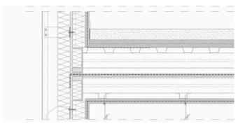
Zwischendecken- und Bodenaufbau von oben nach unten: Bodenbelag, Zementestrich, Dampfbremse, Trittschalldämmung, Trapezblech, Stahlprofil, Modulstoß, Transportabdichtung, Trapezblech, Stahlprofil, Aufdopplung, Gipskartonplatte, Dampfbremse, Gipskartonplatte, Abhangdecke nach Bedarf
