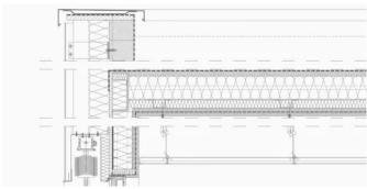
Dachaufbau von oben nach unten: Dichtungsbahn, Gefälledämmung gemäß GEG, Transportabdichtung, Trapezblech, Stahlprofil, Mineralwolldämmung im Gefachbereich, Aufdopplung, Gipskartonplatte, Dampfbremse, Gipskartonplatte, Abhangdecke nach Bedarf
