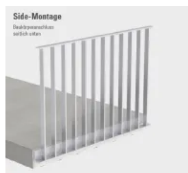
BALUGA easy - Baukörperanschluss seitlich unten
