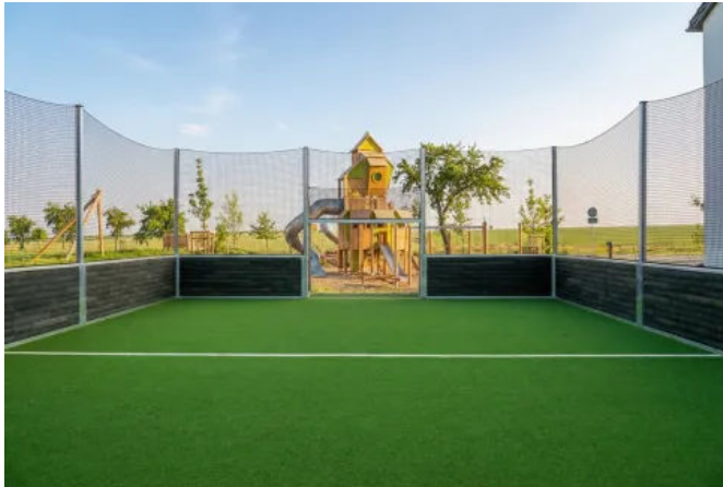
PolyPlay Arena GT mit Bandensystem aus FormaTurf Flexblock-Steinen, die ausrecycelten Kunstrasenmaterialien hergestellt werden und für hohe Stabilität sorgen.
