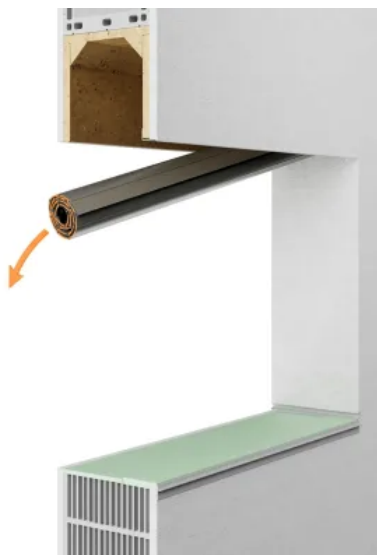
Alten Rollladen aus Kasten entfernen.
