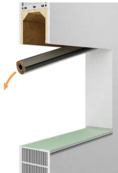
Alten Rollladen aus Kasten entfernen.
