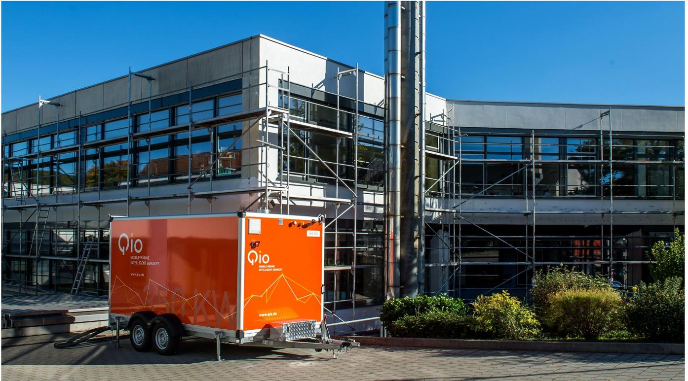
Die mobilen Heizzentralen von Qio mit Wärmeleistungen von 21kW bis 600kW erfüllen alle Anforderungen bei der Überbrückung von Baumaßnahmen an der stationären Wärmeversorgung oder zur Absicherung von Wärmeversorgungssystemen.
