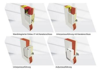
Meltem Einbauvarianten | @Meltem
